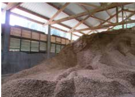
Le bois déchiqueté est mis à sécher à l'intérieur du hangar de Villard-de-Lans en attendant d'être utilisé pour les chaufferies locales
